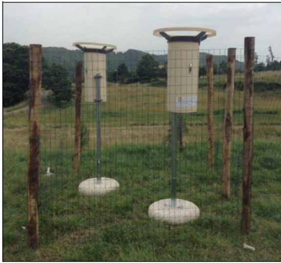
Figura 6.5: Esempi di posizionamento di deposimetri
