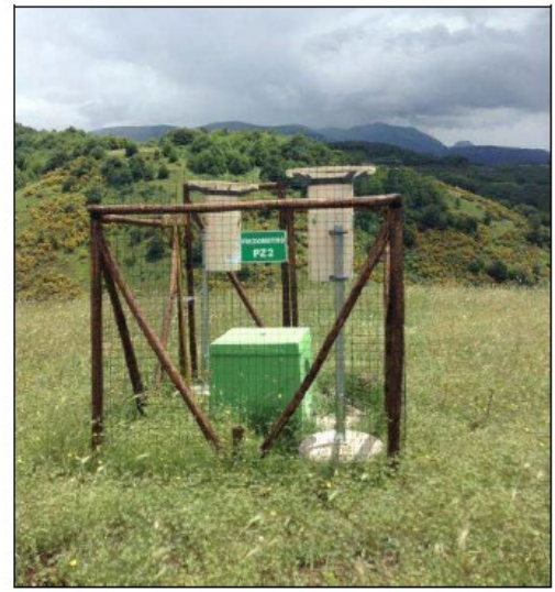
Figura 6.5: Esempi di posizionamento di deposimetri
