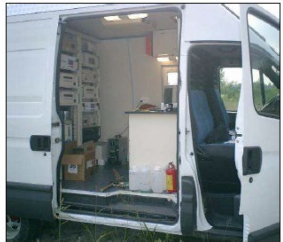
Figura 6.4: Esempi di monitoraggio della qualità dell'aria mediante stazione mobile
