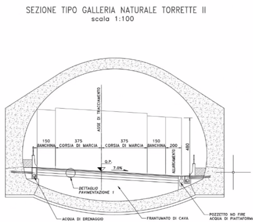
Sezione tipo C1 in galleria naturale Torrette 2.
