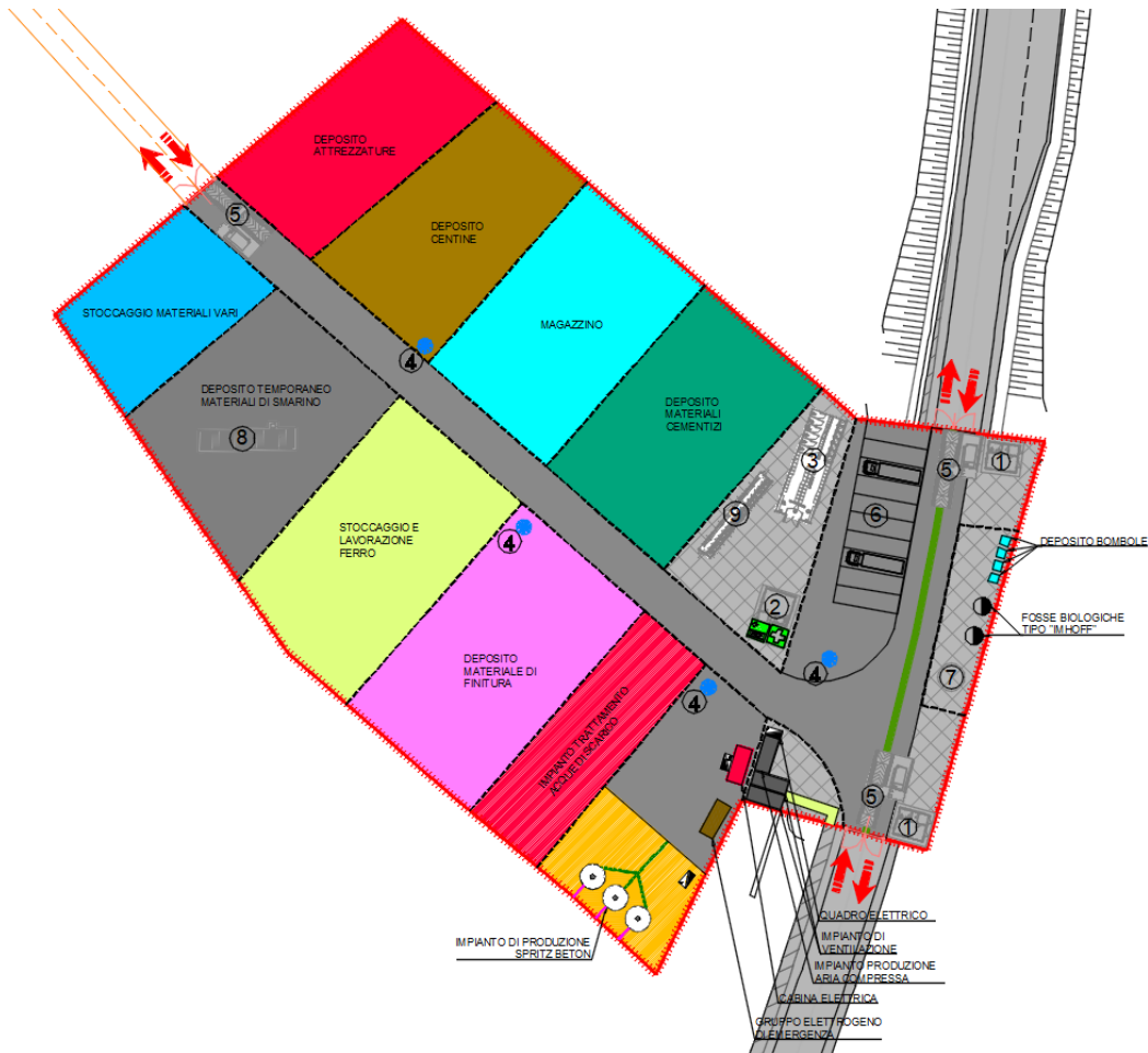
Schema del cantiere imbocco
