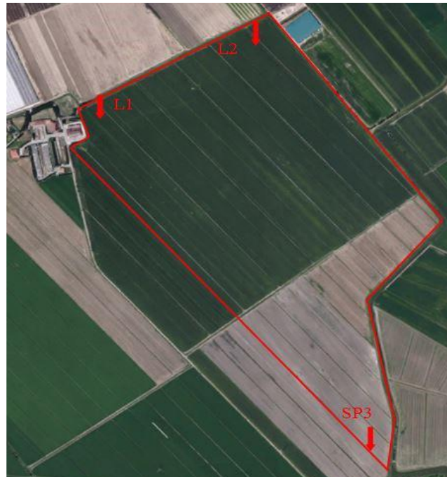
Figura 15: Ortofoto con individuazione dei punti di esecuzione dei sondaggi geognostici L1 e L2, e del piezometro SP3
