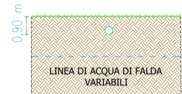
COLLETORE DI PRIMA RACCOLTA DRENI Ø 400 mm IN P.V.C.
