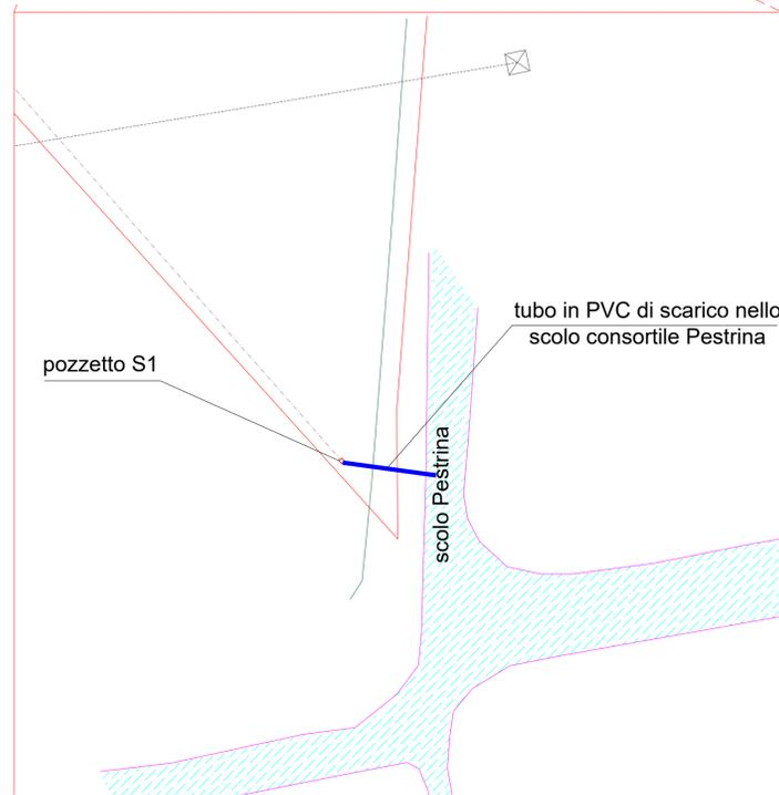
PLANIMETRIA CON TUBO DI SCARICO SCALA 1:1000
