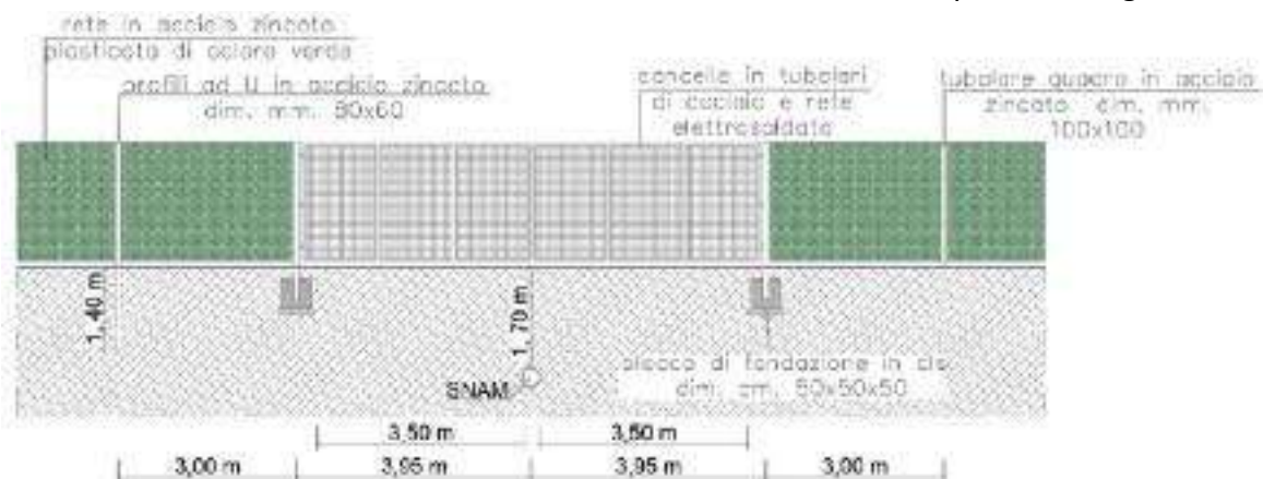
Figura 12: attraversamento della fascia di rispetto con la recinzione e cancello di accesso nella zona 1.
