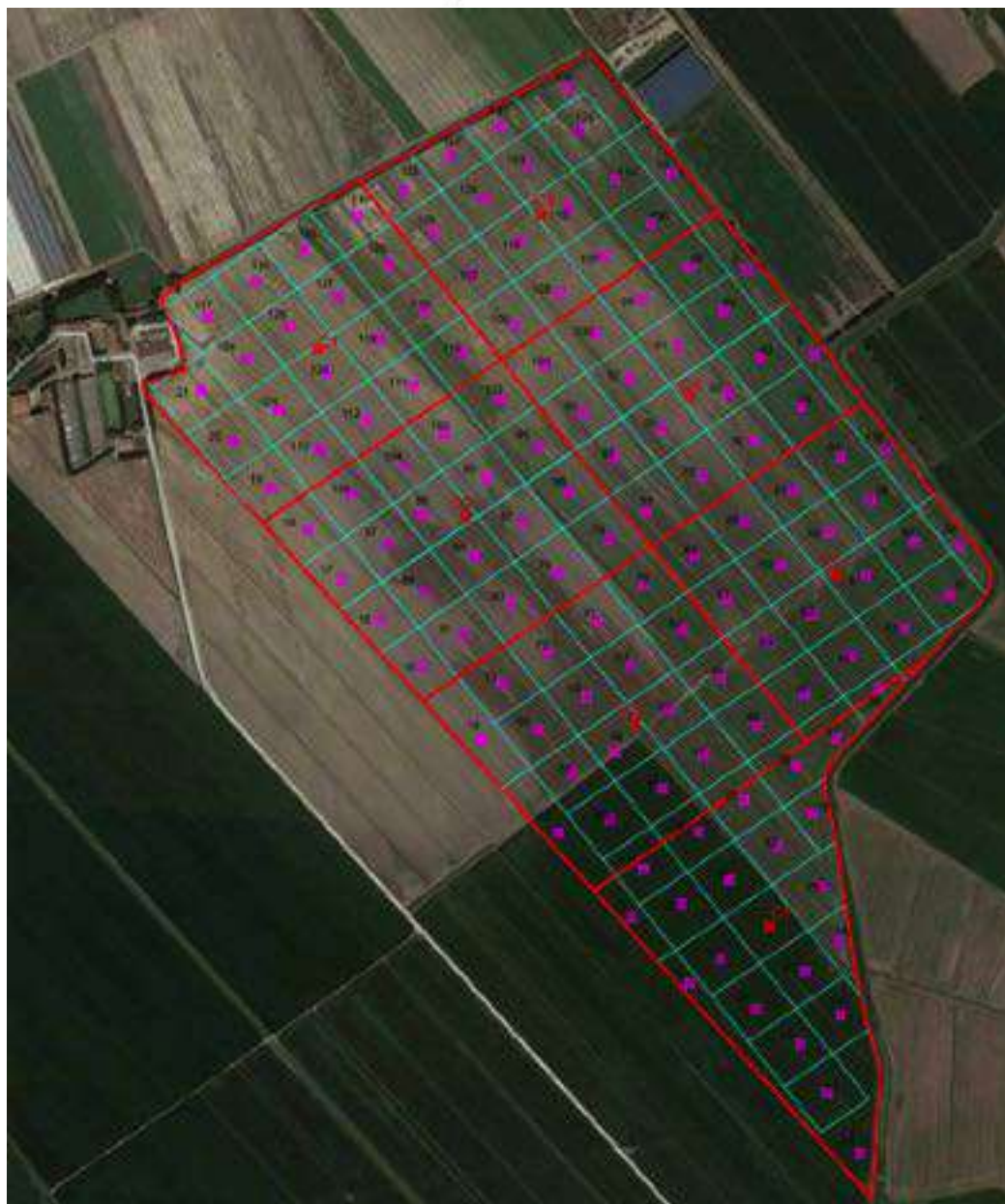
Fig.9 Mappatura del sito di progetto in 138 aree per il prelevamento dei campioni
