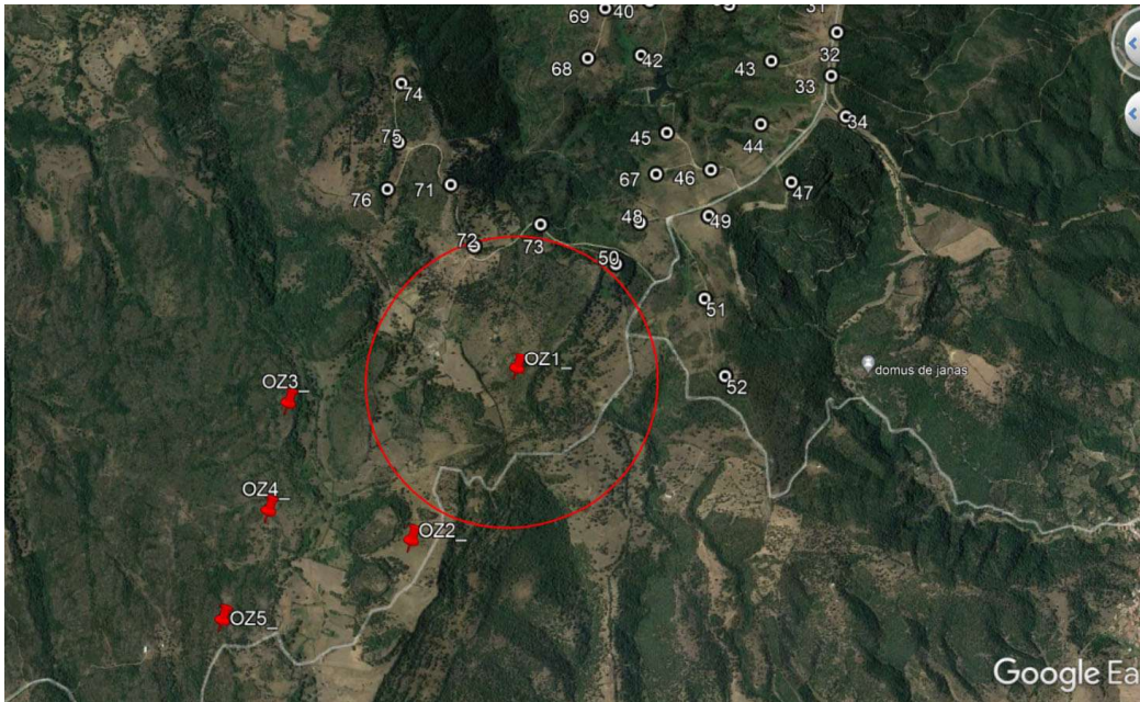
Figura 2: Distanza minima Impianto Eolico di Ischinditta rispetto ai due impianti eolici di proprietà di Enel (Tula 1 e Tula 2)_ cerchio in rosso raggio di 700 m
