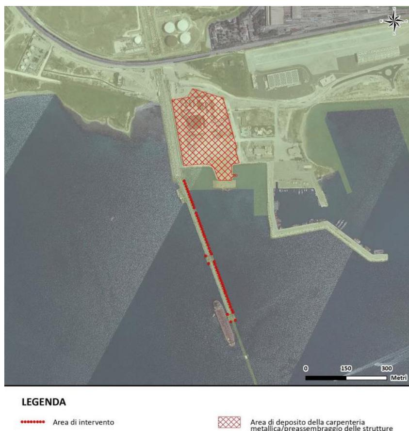
Fig.3 – Corografia del pontile con indicazione in rosso dell'intervento proposto e dell'area di cantiere
