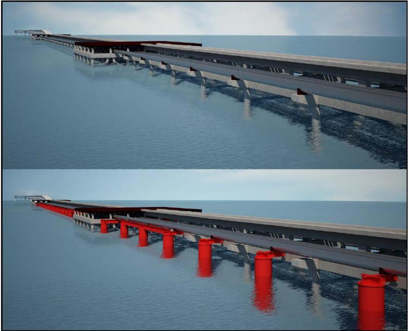
Fig.4 – Rendering dell'intervento ante (sopra) e post-operam (sotto); in rosso sono evidenziati i pali di fondazione previsti in progetto
