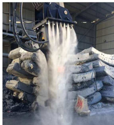
Figura 12.9: Esempi di corone di ugelli montate sugli utensili demolitori
