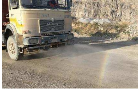
Figura 12.8: Immagini esemplificative dei metodi di bagnatura con autobotte con barra distributrice con ugelli correttamente spaziatati in posizione posteriore e frontale
