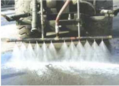
Figura 12.8: Immagini esemplificative dei metodi di bagnatura con autobotte con barra distributrice con ugelli correttamente spaziatati in posizione posteriore e frontale
