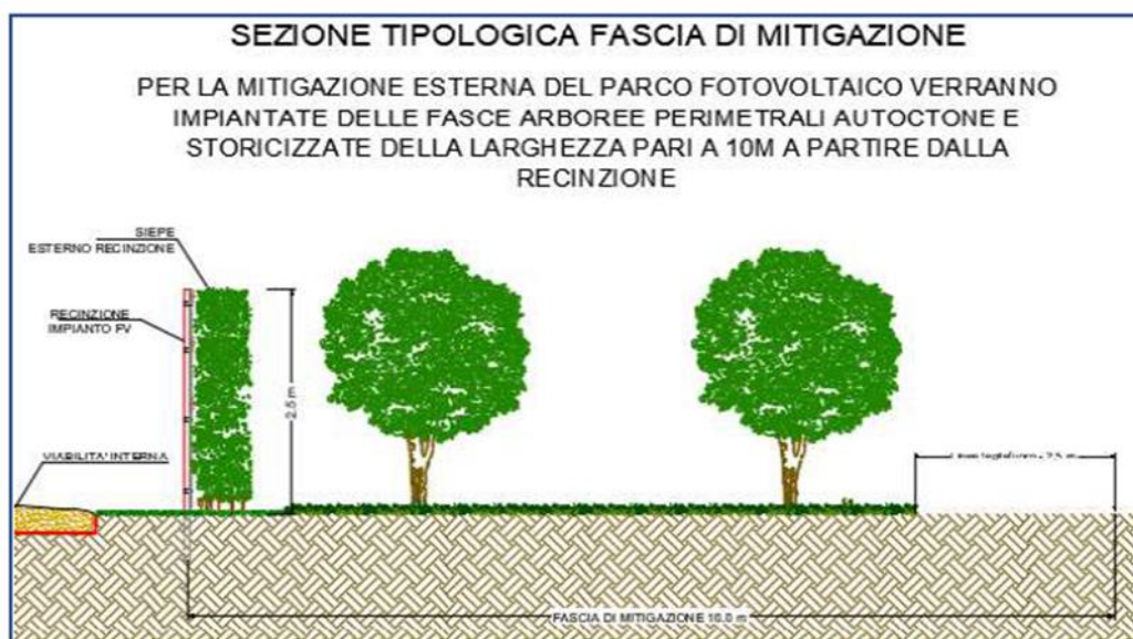
Figura.10- Sezione tipologica fascia di mitigazione perimetrale
