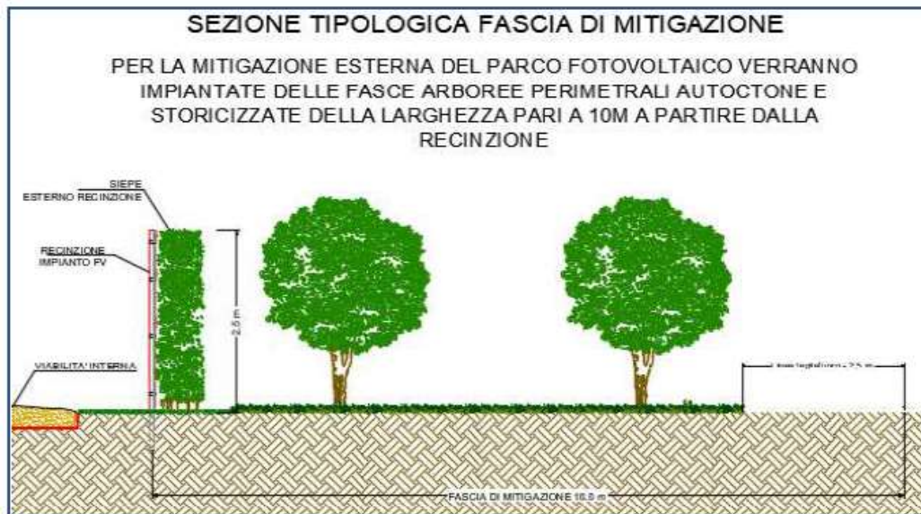
38 - Sezione tipologica fascia di mitigazione perimetrale
