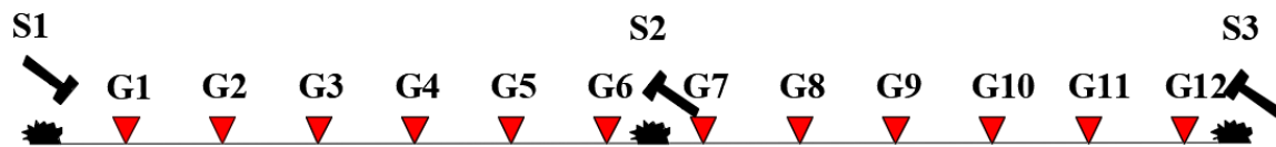
Fig. 2.2.1: Geometria tipo dello stendimento sismico.
