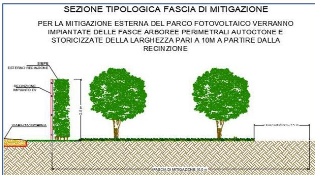
Figura 6 – Sezione tipologica fascia di mitigazione perimetrale
