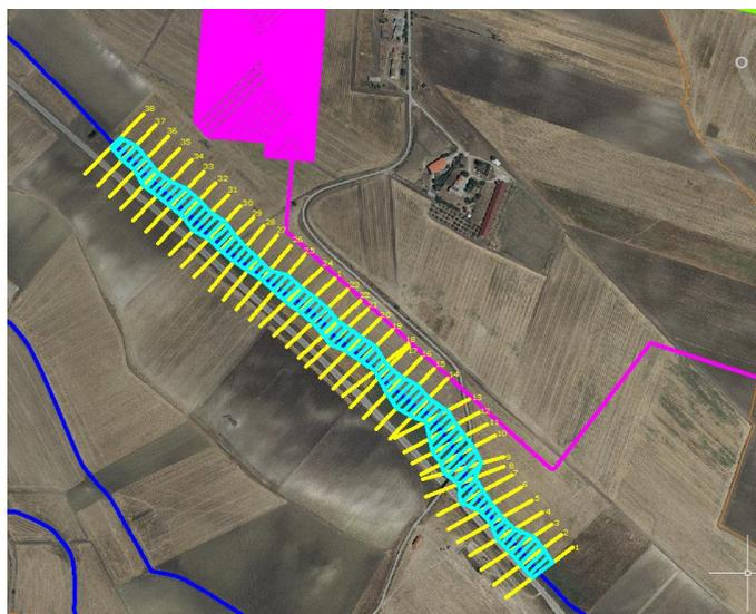
**Figura 15** – individuazione dell'area allagabile determinata con  $Tr$  200 anni. In magenta il cavidotto AT interrato
