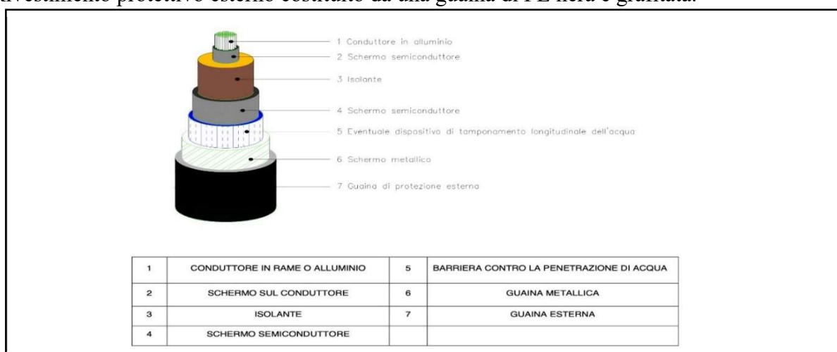
Figura 6-1 Caratteristiche tecniche Cavo AT per trasporto energia
