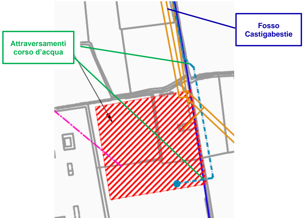
Figura 5-27 Attraverso corso d'acqua flowline Cluster E
