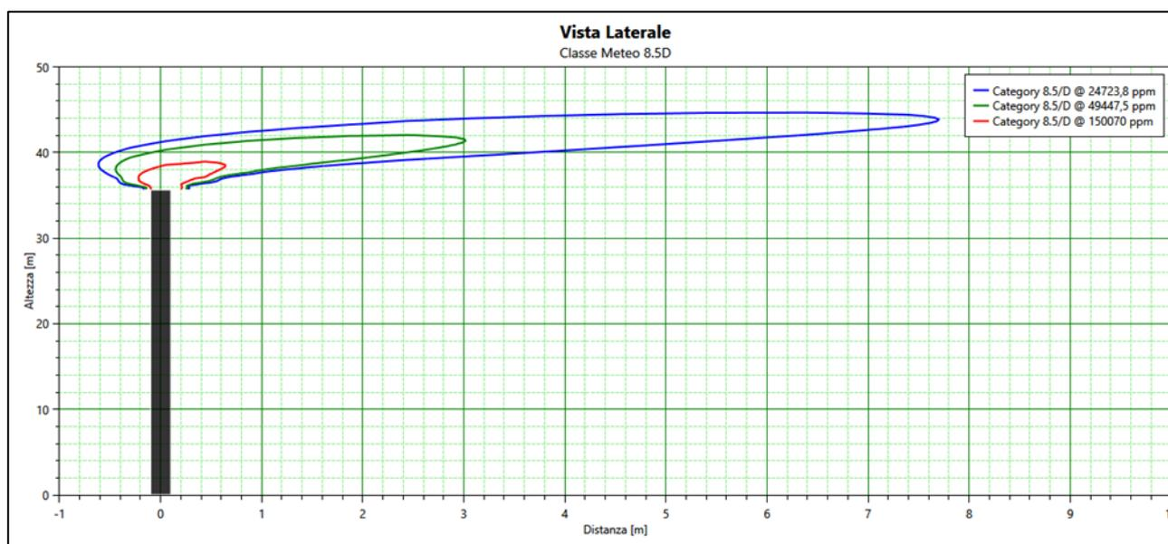
**Figura 4 - Dispersione nube infiammabile - Classe Meteo 8.5D**
