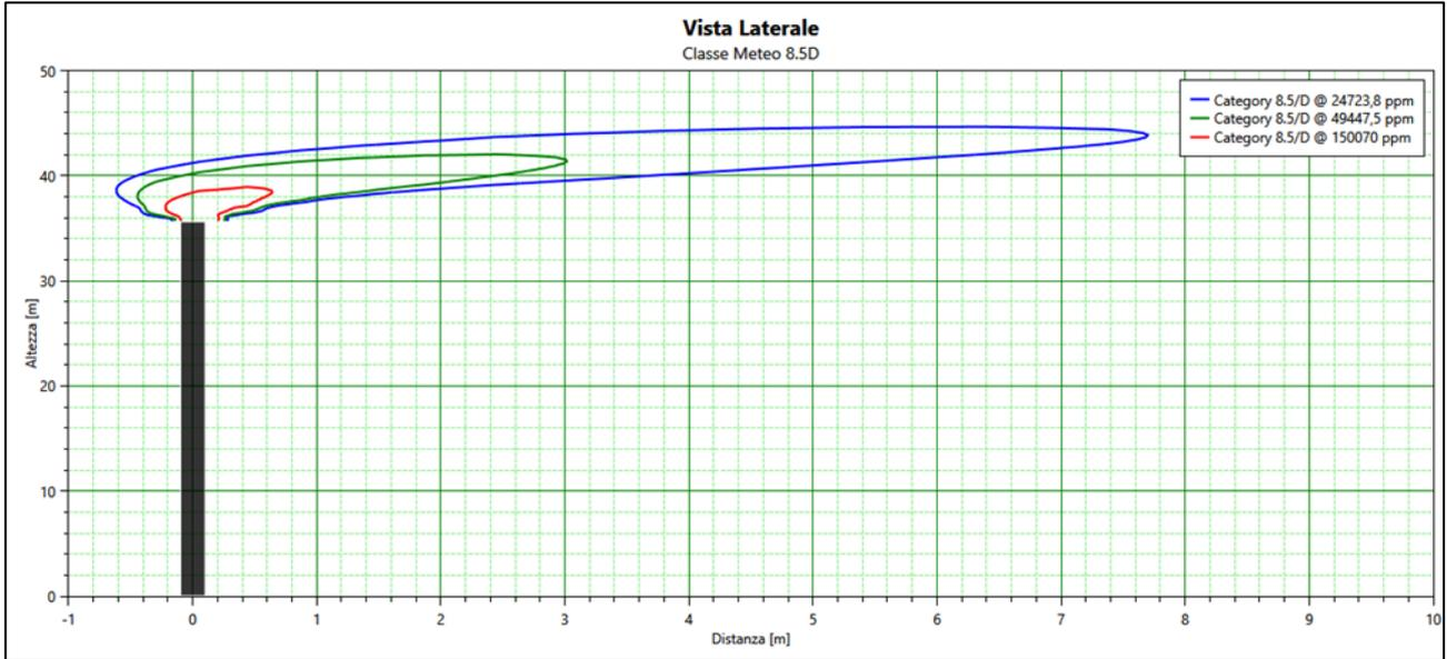
**Figura 8- Dispersione nube infiammabile - Classe Meteo 8.5D**
