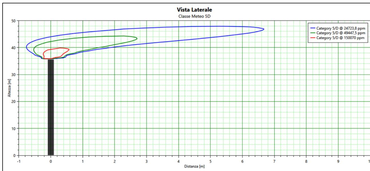
Figura 7- Dispersione nube infiammabile - Classe Meteo 5D
