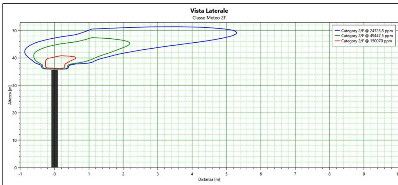
Figura 6- Dispersione nube infiammabile - Classe Meteo 2F
