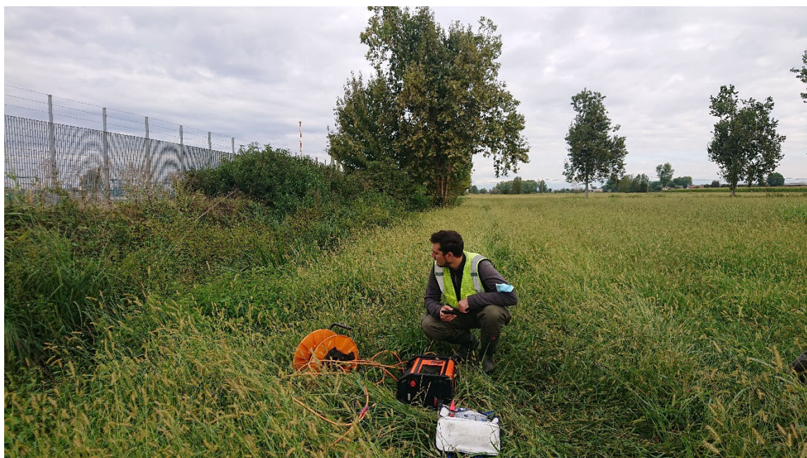
Figura 8.5: Acquisizione dei dati geoelettrici con georesistivimetro Abem LS2– tratto sud-
