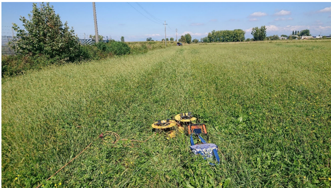
Figura 8.1: Acquisizione dei dati geoelettrici con georesistivimetro Abem LS2 – zona centrale -
