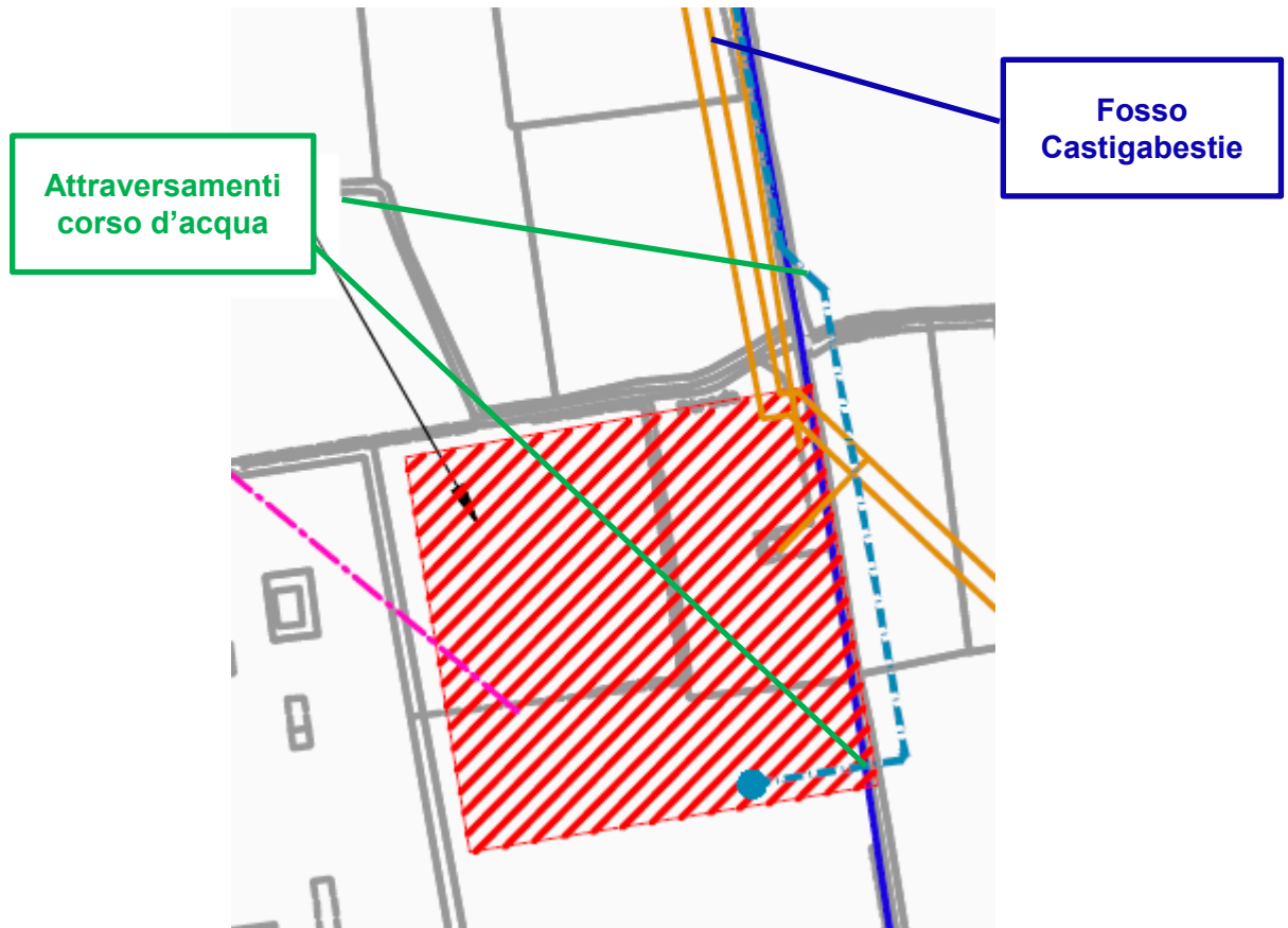
Figura 3-24 Attraverso corso d'acqua flowline Cluster E
