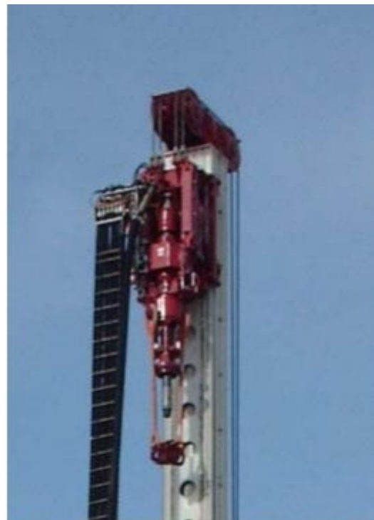
Figura 3-35 Impianto di perforazione HH220: top drive
