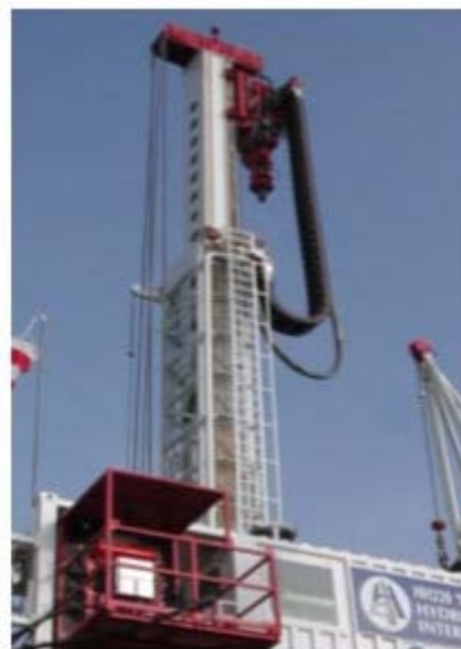
Figura 3-34 Impianto di perforazione HH220: sistema di sollevamento
