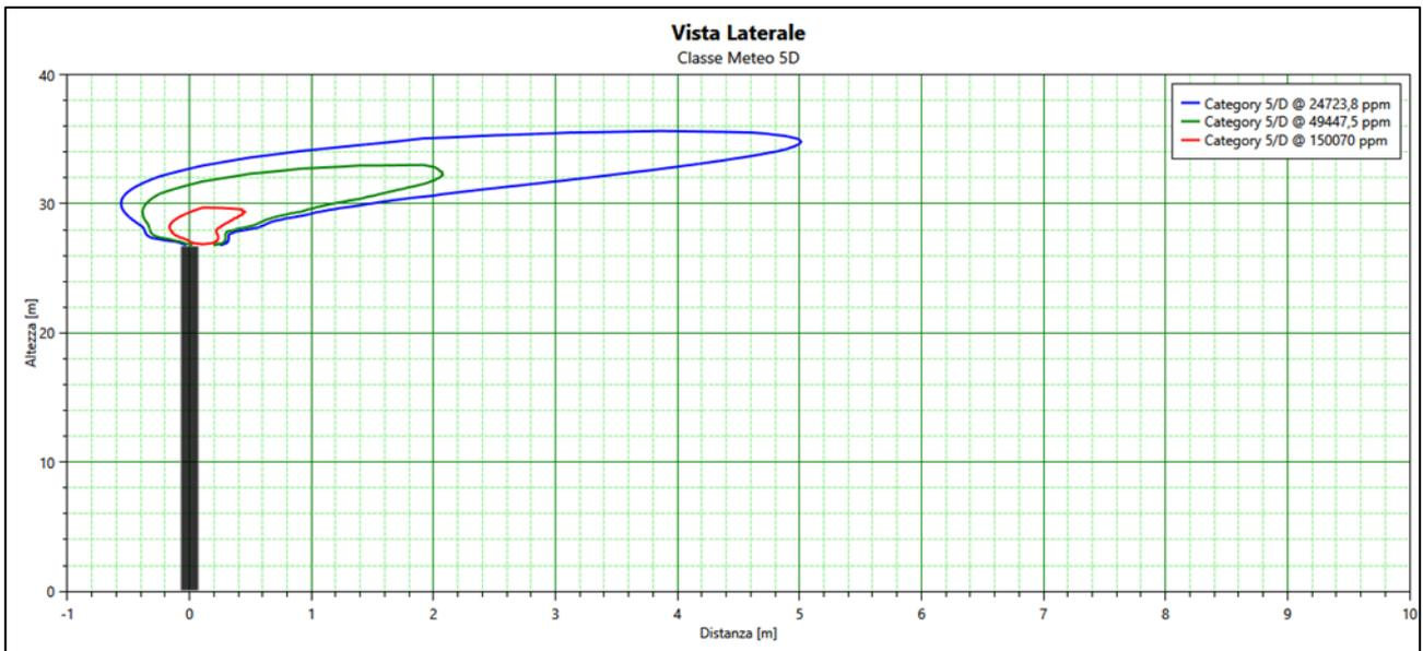
Figura 7- Dispersione nube infiammabile - Classe Meteo 5D
