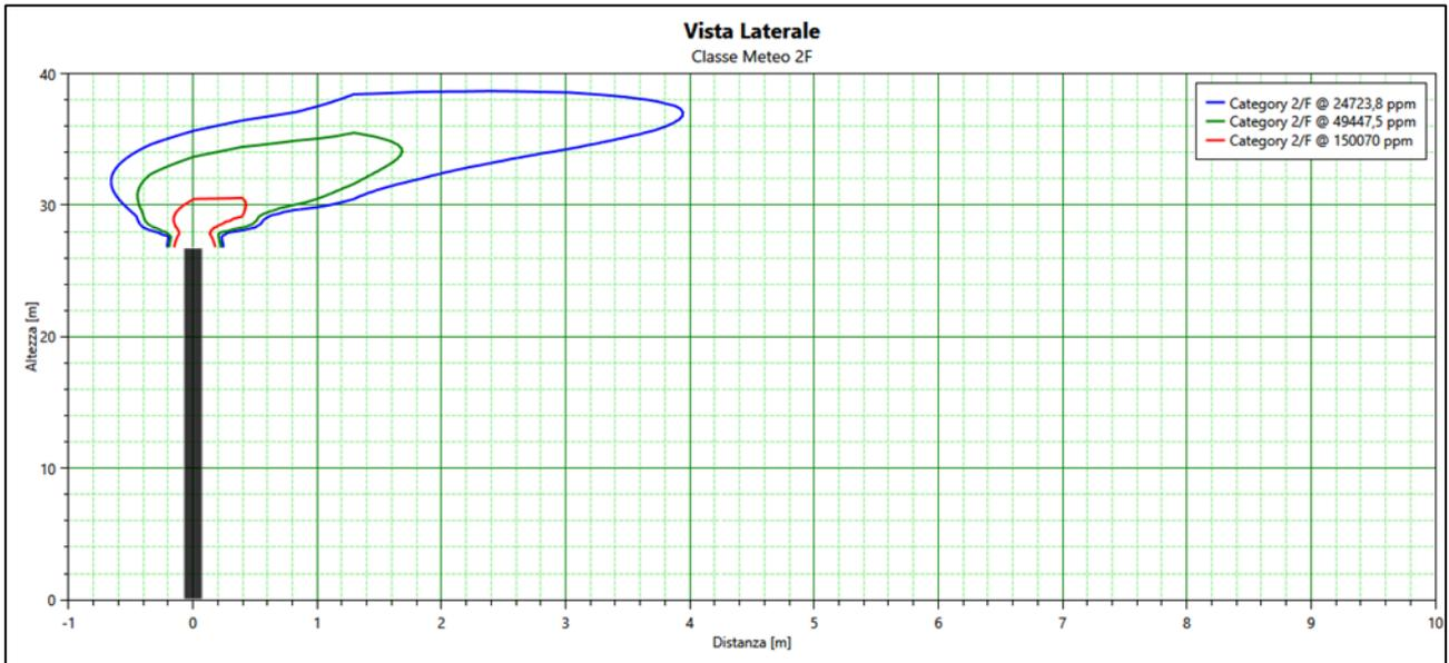
Figura 6- Dispersione nube infiammabile - Classe Meteo 2F
