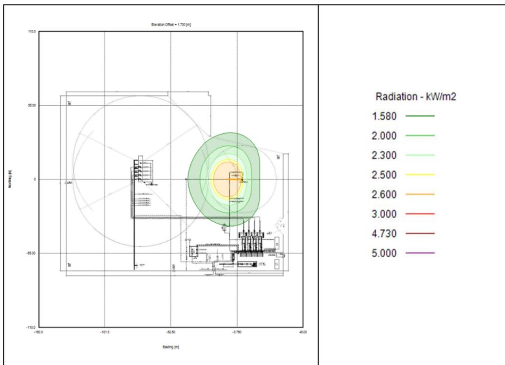
Figura 2 - Mappa di irraggiamento - Pianta
