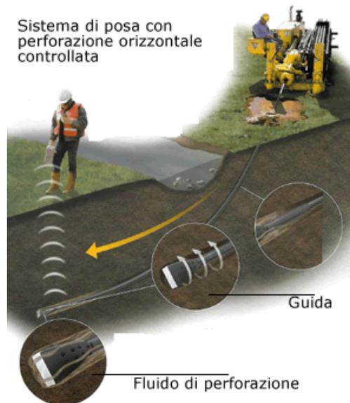
**FIG 2 Sistema di trivellazione orizzontale controllata (T.O.C.).**
