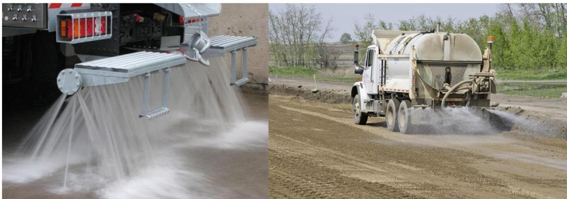
**Figura 2-66: Automezzo per la bagnatura delle piste sterrate**
