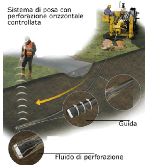
**FIG 1 Sistema di trivellazione orizzontale controllata (T.O.C.).**
