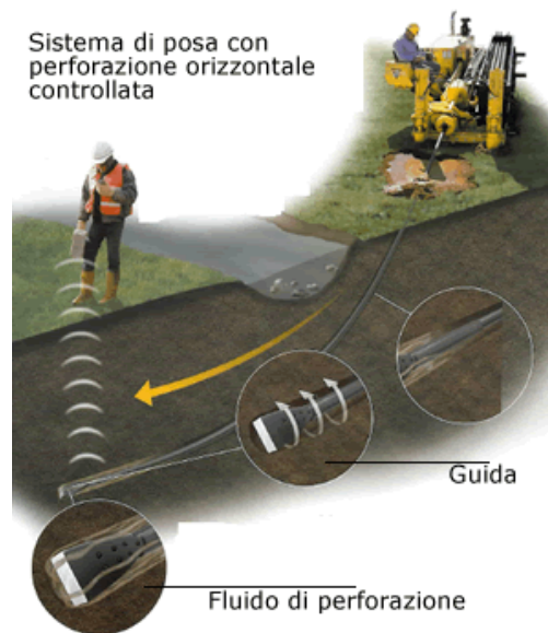
FIG 1 Sistema di trivellazione orizzontale controllata (T.O.C.).
