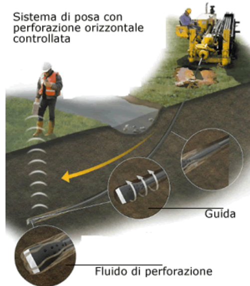
FIG 4 Sistema di trivellazione orizzontale controllata (T.O.C.).
