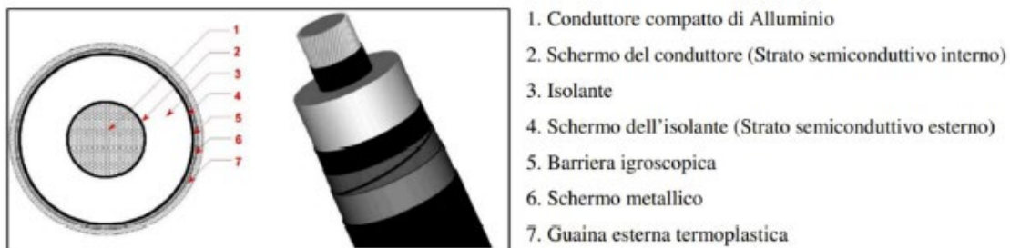
Figure 14 - Particolare – Cavo impiegato linea di Alta Tensione
