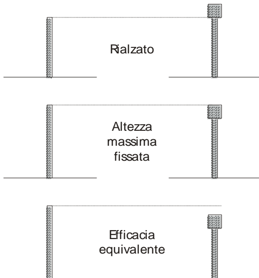
Figura 4 tipologie di analisi sugli elementi antidiffrattivi
