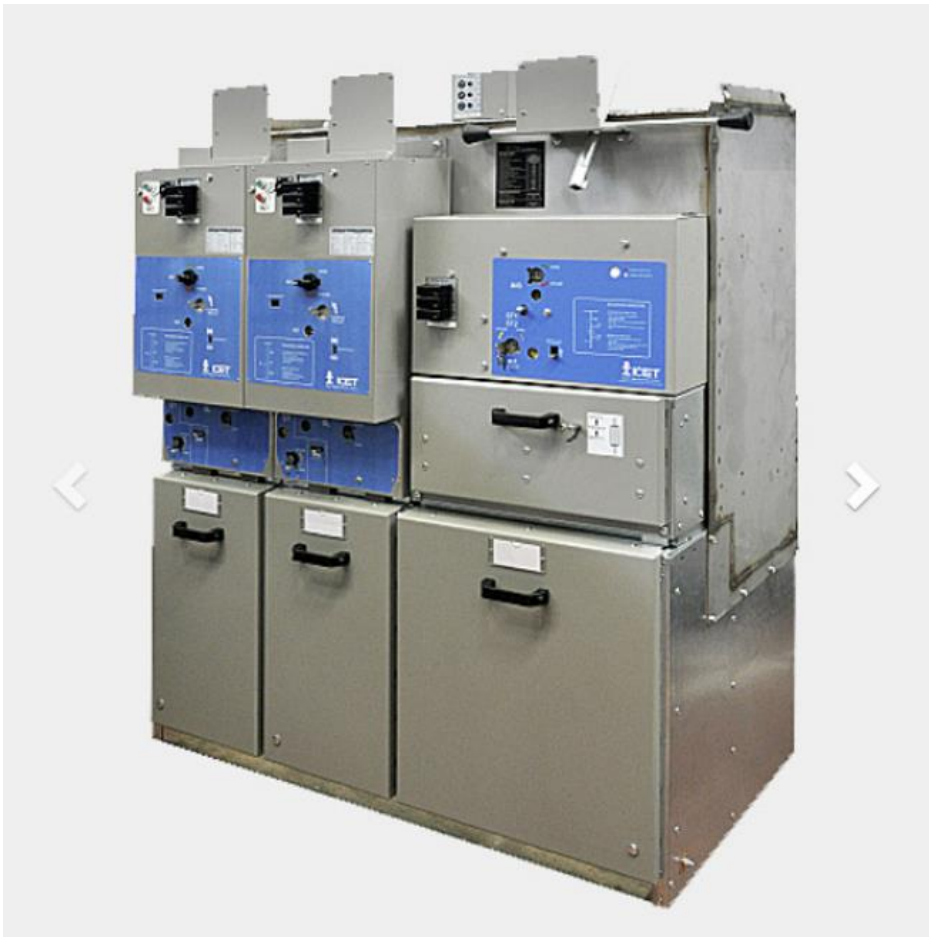
Esempio di Quadro di Media Tensione isolato in SF6 con interruttori ad azionamento elettrico e unità IMS, TA e TV omologate Enel conformi a DY808
