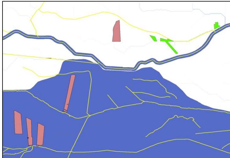
Figura 8. Aree impianto Sigonella (in rosso) – Sovrapposizione con area pericolosità idraulica PAI P3 (in blu)
