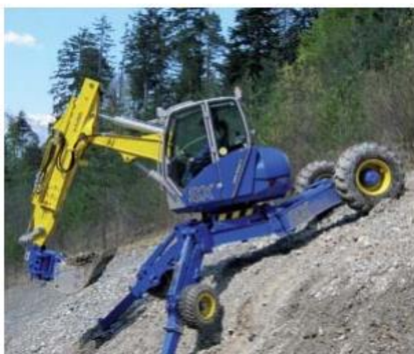
Figura 100 – Escavatore del tipo Ragno
