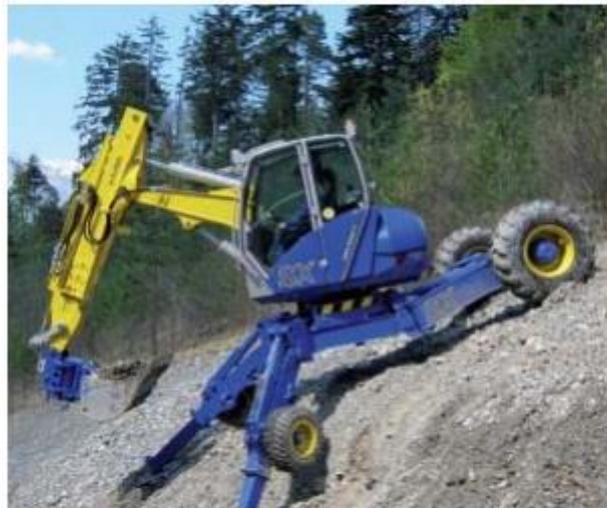
Figura 39 – Escavatore del tipo Ragno
