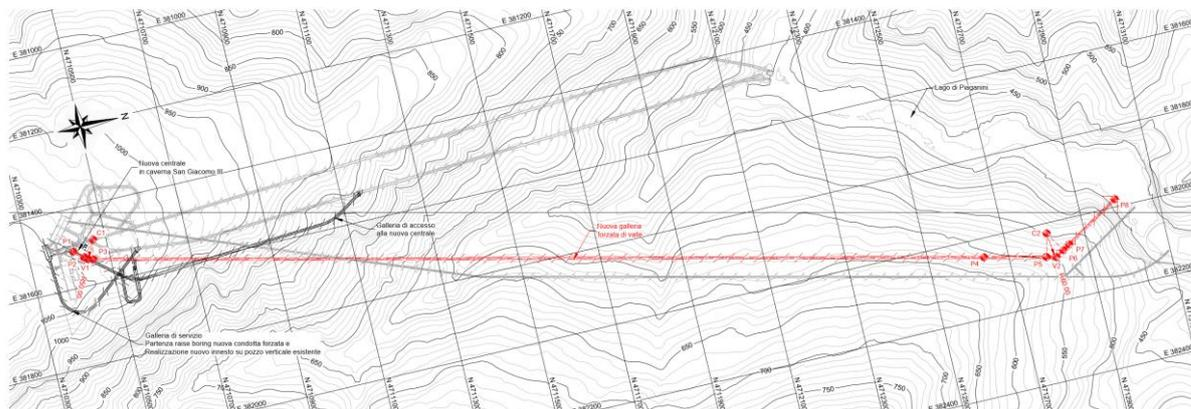
Figura 50: Nuova galleria forzata di scarico/aspirazione sulla derivazione Piaganini – pianta.
