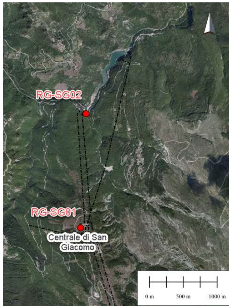
Figura 7: Planimetria con l'ubicazione delle postazioni di rilievo geomeccanico. Il rilievo RG-SG01 è stato realizzato in caverna, in carta è rappresentata la sua proiezione in superficie.
