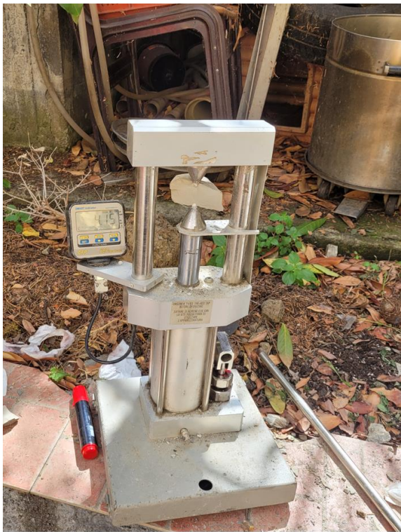
Figura 1: esempio di esecuzione di una prova mediante apparato di Point-Load.
