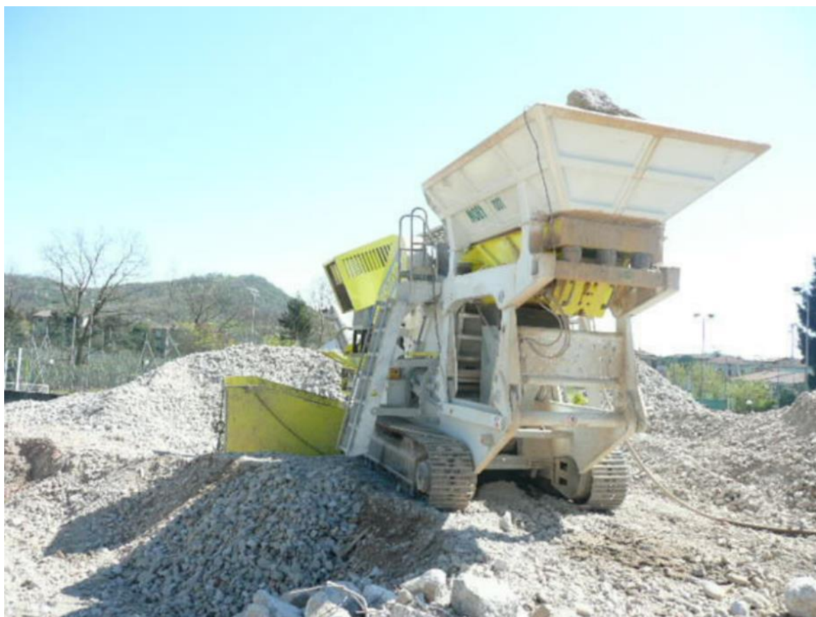
Figura 19: Esempio impianto di frantumazione mobile
