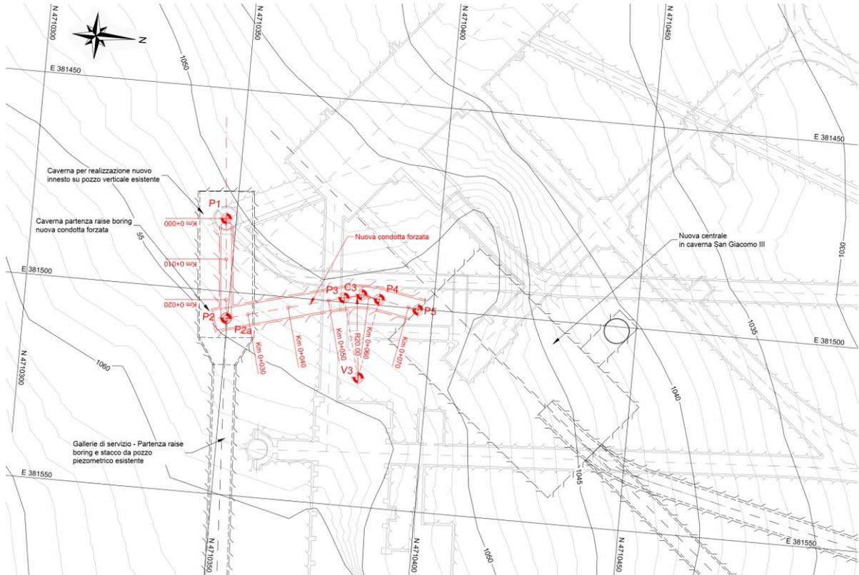
Figura 36: Nuova connessione al pozzo forzato esistente di San Giacomo II – pianta.
