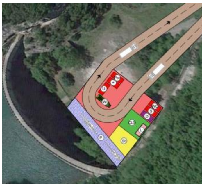
Figura 93: Area di cantiere a valle della diga Piaganini
