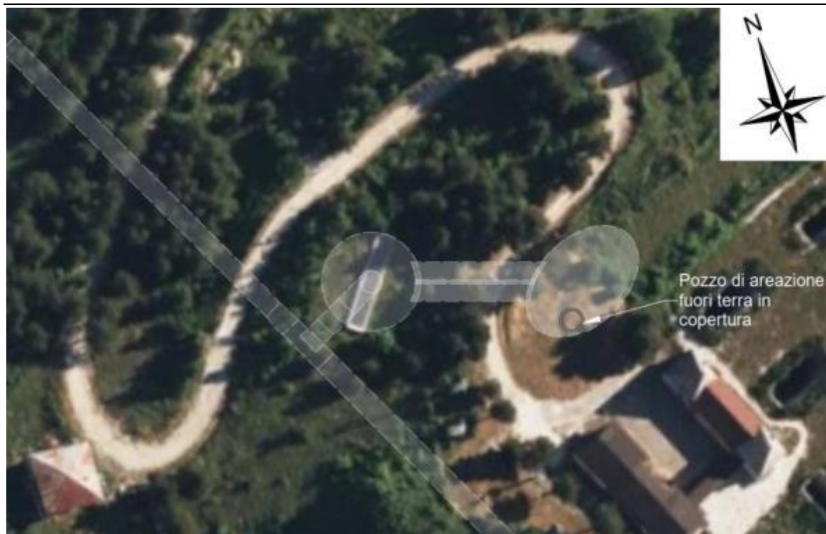
Figura 86: Nuova camera di espansione al pozzo piezometrico sulla derivazione Provvidenza – inquadramento
