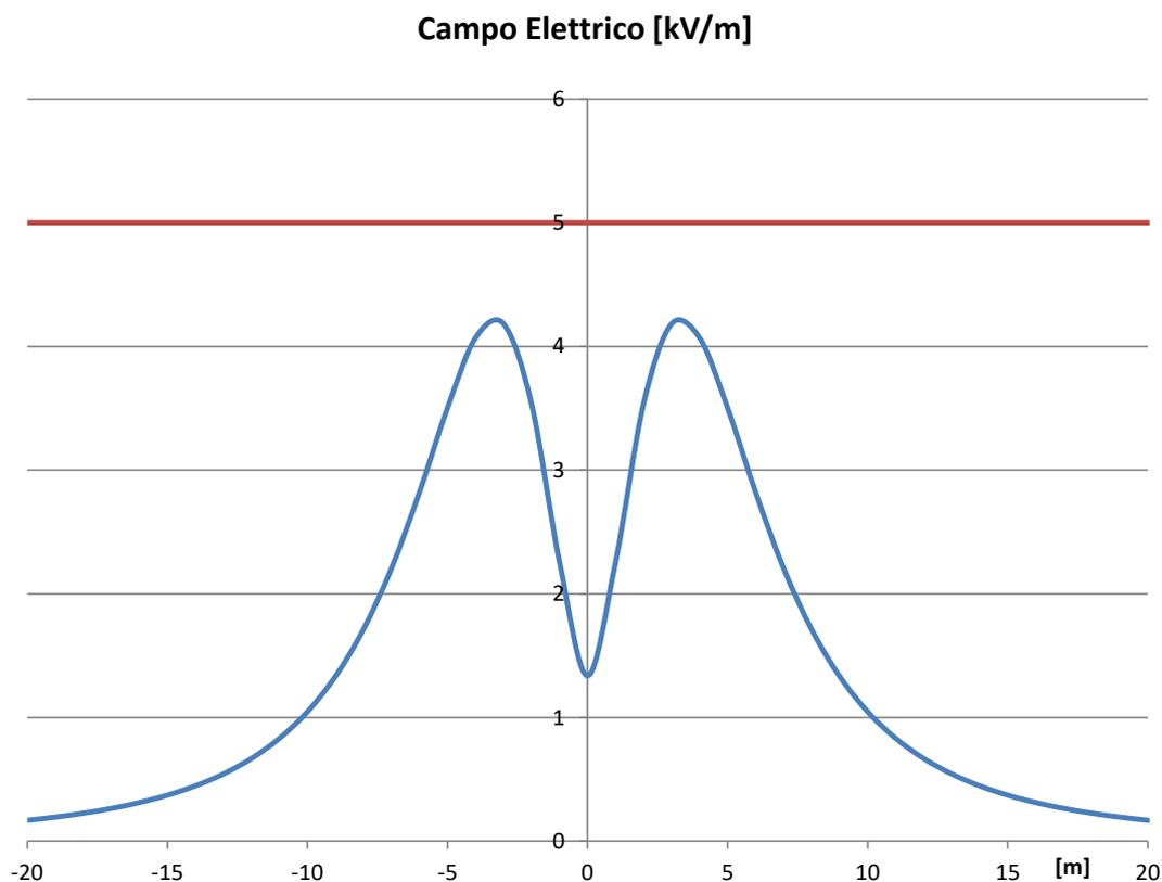
**Figura 14: Campo elettrico al suolo generato dal sistema di sbarre a 150 kV**
