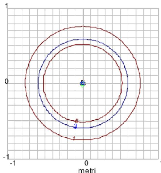
**Figura 1: Curve di equilivello per il campo magnetico di una linea MT in cavo elicordato interrata (dalla Norma CEI 106-11)**
