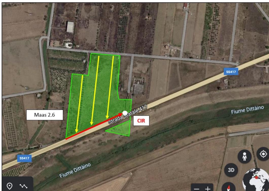
Figura 7. Campo Maas 2.6 – Individuazione sistema di laminazione (in rosso, elementi del sistema di laminazione; in giallo, direzioni di deflusso degli elementi di drenaggio non a scopo di laminazione)
