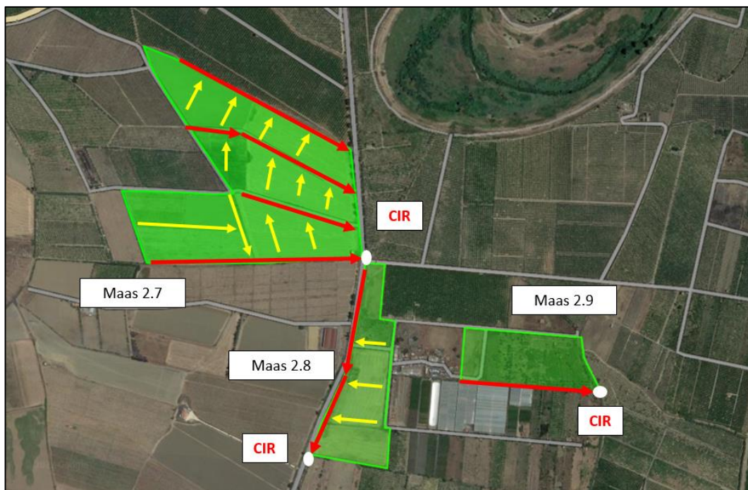
Figura 8. Campi Maas 2.2.7-8-9 – Individuazione sistema di laminazione (in rosso, elementi del sistema di laminazione; in giallo, direzioni di deflusso degli elementi di drenaggio non a scopo di laminazione)
