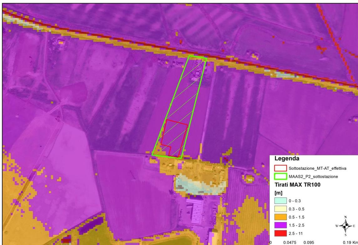
Figura 23 – Impianto Maas 2 – Sottostazione elettrica MT-AT – Confronto fra ingombro area nella disponibilità del Proponente (in verde) e superficie effettivamente occupata dalla sottostazione (in rosso)
