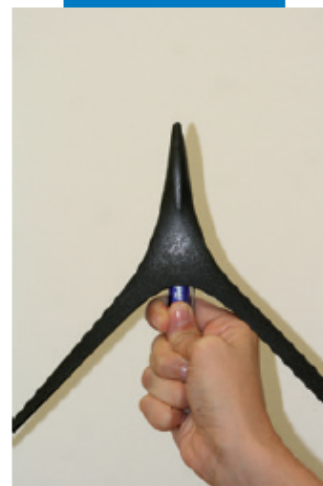
Prova empirica della resistenza a punzonamento e della elevata elasticità di Plastimul 2K Reactive
