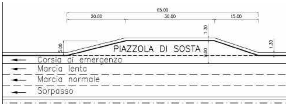
Figura 2-3 Piazzole di sosta in rilevato/trincea
