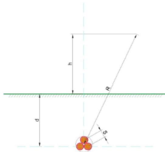
Mediante modello di calcolo bidimensionale, basato sul metodo standardizzato dal Comitato Elettrotecnico Italiano, per il cavo unipolare interrato posato a trifoglio, il valore dell'induzione magnetica massima, calcolata al livello del suolo, è in prima approssimazione pari a:
