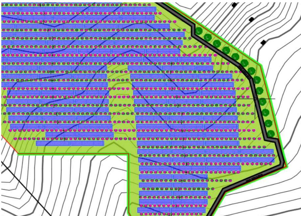
6- particolare fascia di mitigazione e interfila layout di progetto
