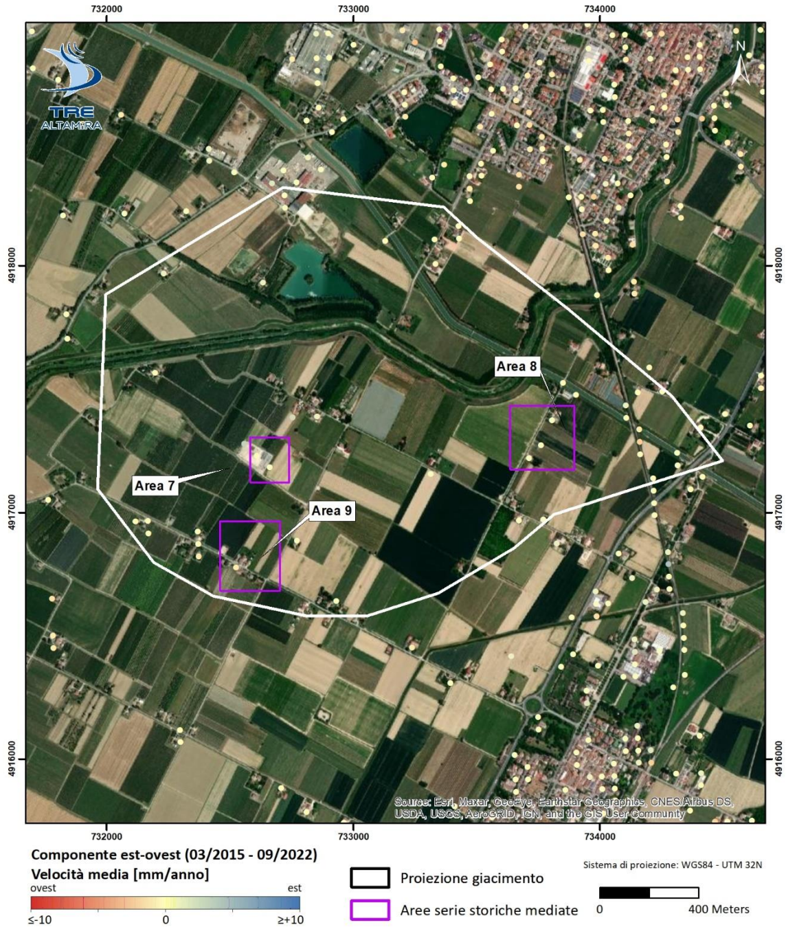
Figura 23: Dettaglio dei risultati della componente orizzontale est-ovest (velocità media) sull'area del Pool C. La serie storica media dei punti compresi nell'area 7 è mostrata in Figura 25.
