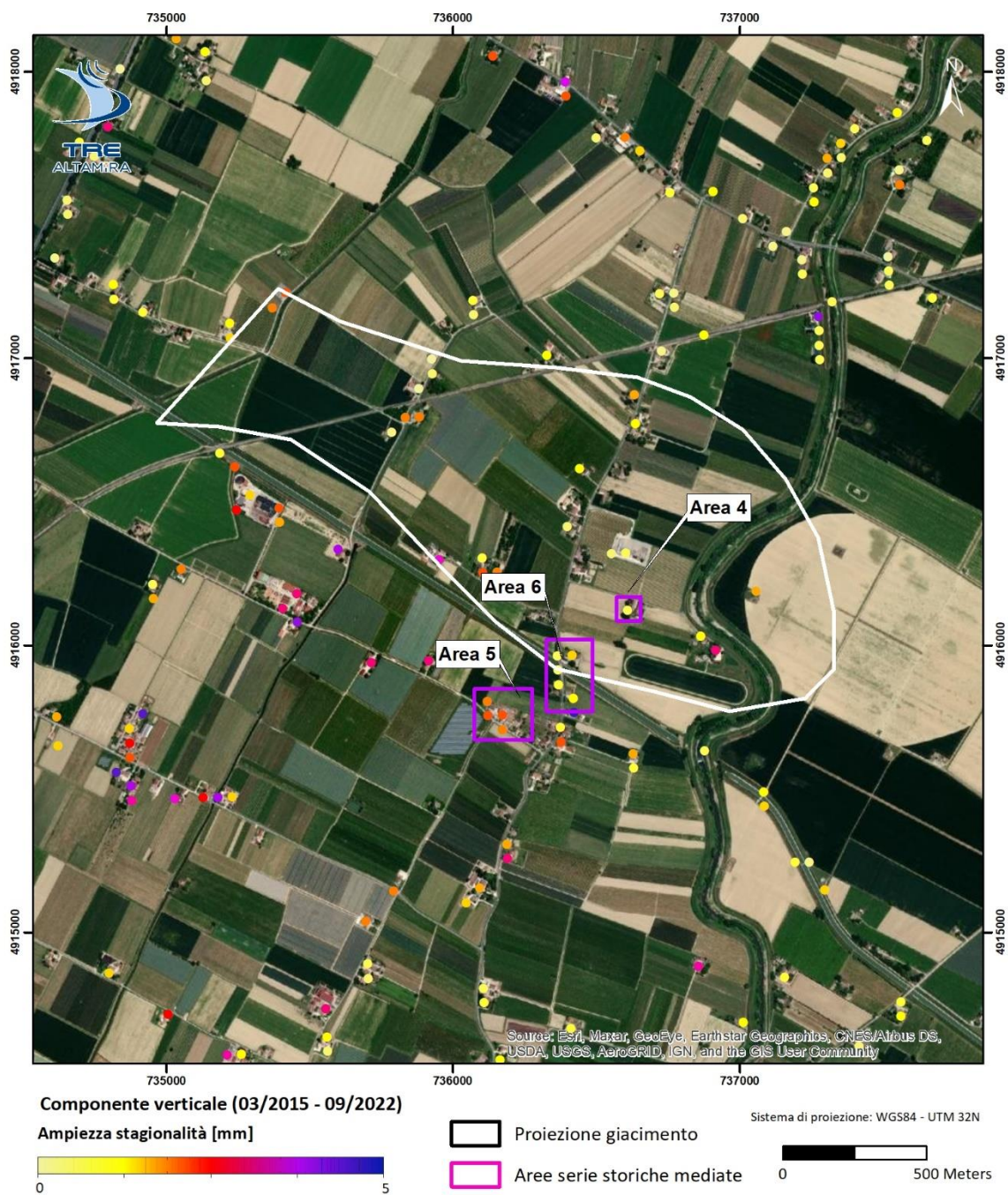
Figura 16: Dettaglio della stagionalità media per la componente verticale nell'area del Cluster B di Cotignola
