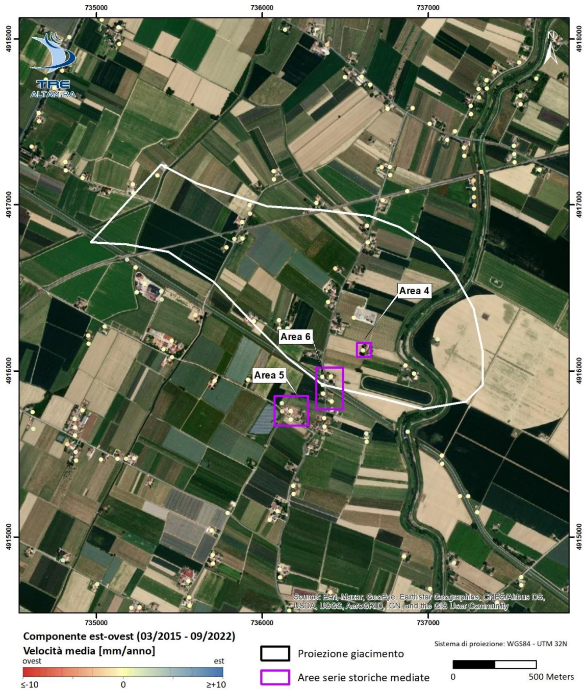
Figura 18: Dettaglio della componente est-ovest nell'area del Pool B. Le serie storiche dei punti all'interno delle aree viola sono stati mediate per ottenere le serie storiche mediate mostrate in Figura 19
