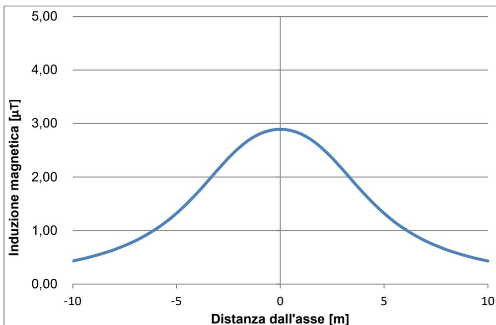
Figura 5-1 – Andamento campo magnetico sbarre AT stazione utente
