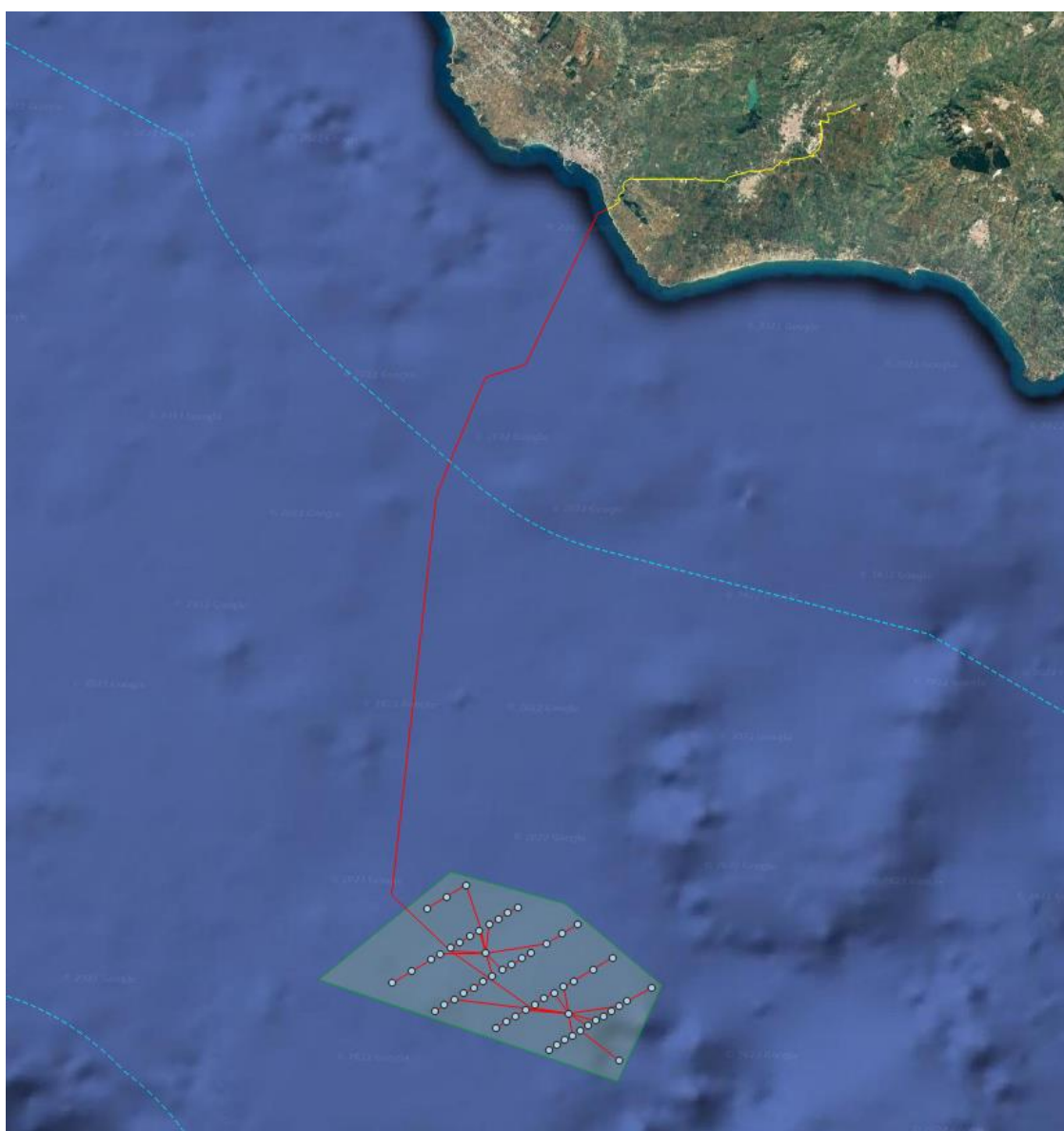
Figura 2 – Localizzazione del parco eolico, con posa in mare e a terra, da stazione offshore a RTN Partanna (TP)
