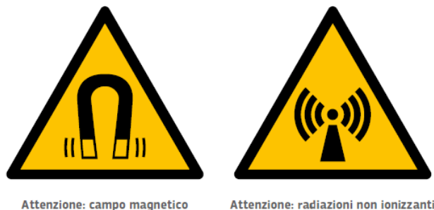
Figura 9.6 — Cartelli di avvertimento standard affissi in relazione ai campi elettromagnetici
