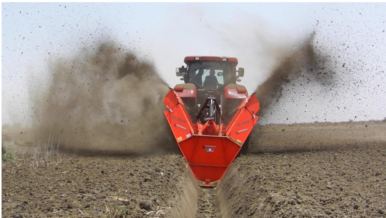
FIG. 12 - MACCHINA SCAVAFOSSI DEL TIPO ROTATIVA BIRUOTE
