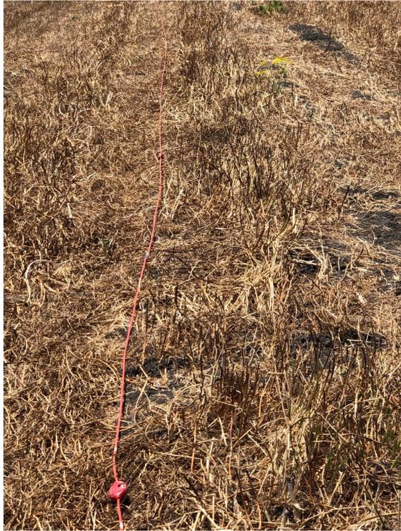
Foto Stendimento di sismica a rifrazione Rz3.
