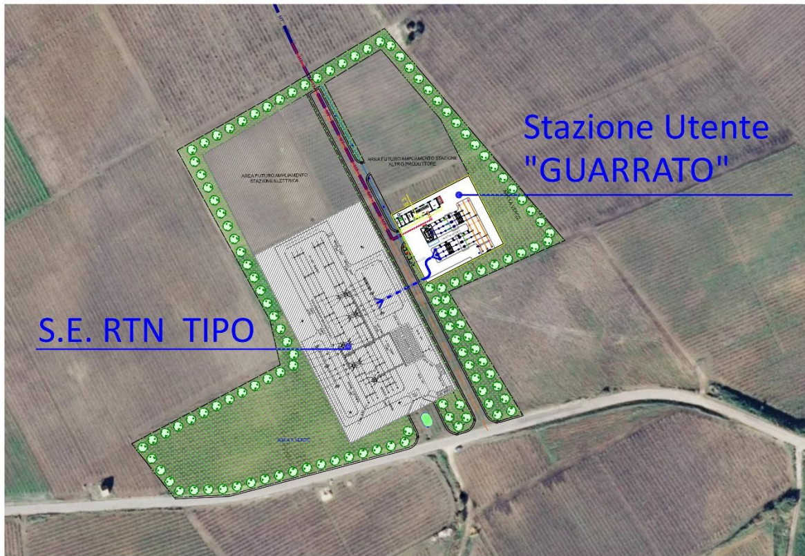
Fig. 7 . Stralcio Stazione Elettrica ed Utente
